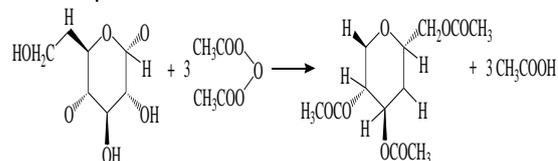
**Gambar 1.** Reaksi umum pembentukan selulosa asetat (Gaol dkk., 2013)
